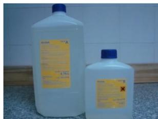
Se utilizan dos tipos de soluciones químicas distintas: revelador y fijador. Ambas se utilizan en las máquinas reveladoras de las placas radiográficas.
